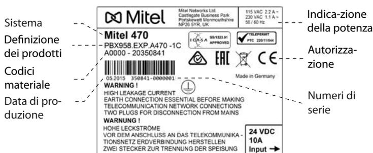
Fig. 87 Targhetta di identificazione Mitel 470 server di comunicazione
